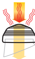
Tvar zbernej plochy svetlovodu s priemerom tubusu 350 mm
